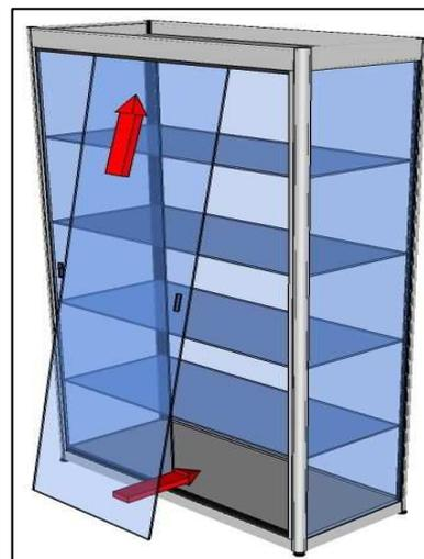
*(Si toutefois les portes ne rentrent pas facilement, utiliser une clé Allen de 5 mm pour dévisser et remonter légèrement la traverse supérieure et faciliter l'insertion des deux portes, puis revisser la traverse dans sa position initiale)*
