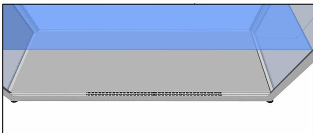
**5 - PORTES** : Attention au sens des onglets, côté extérieur de la vitrine. Placer le haut de la porte dans la coulisse haute et amener la porte vers le bas sur les cages à billes.
